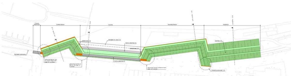
Figuur 3-1 Bovenaanzicht kansrijk alternatief 1: Integrale ambitie & Courtine volledig binnenwaartse klepkering
