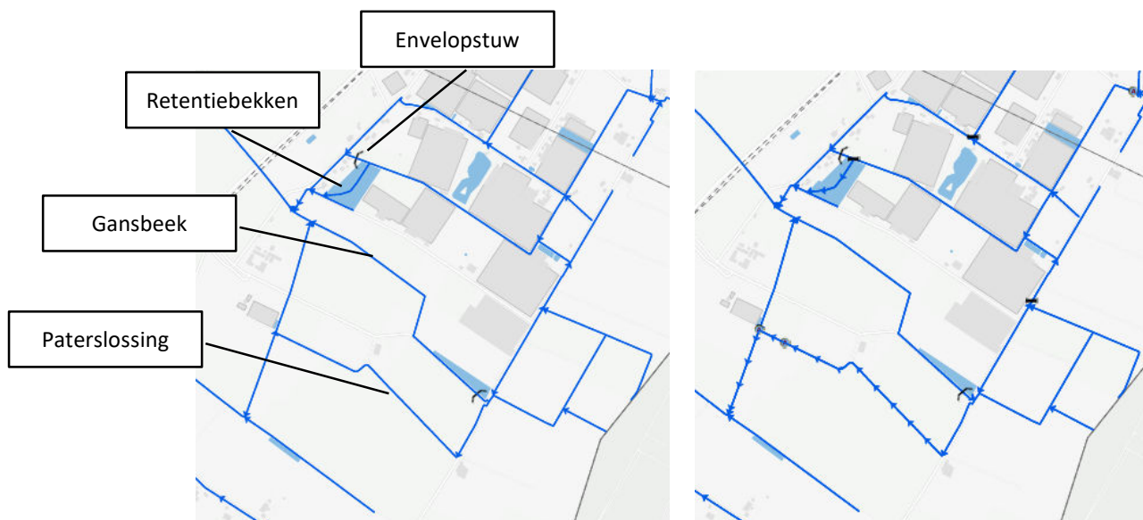
Figuur 2-3 Weergave Paterslossing, Belfelderbroekbeek, Gansbeek en Retentiebekken in reguliere situatie (links) en bij piekafvoeren (rechts)
