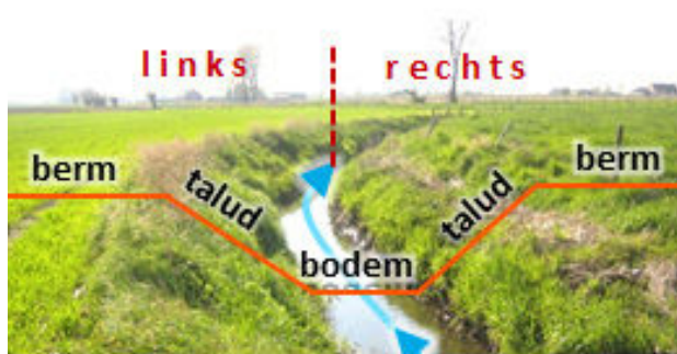
Figuur 4-1 Aanduiding delen van een waterloop
