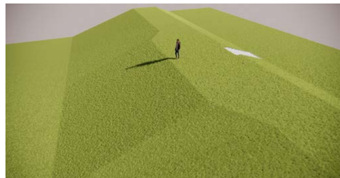
Figuur 136. Principe plaatselijke steiler talud voor vloeiende teenlijn.
