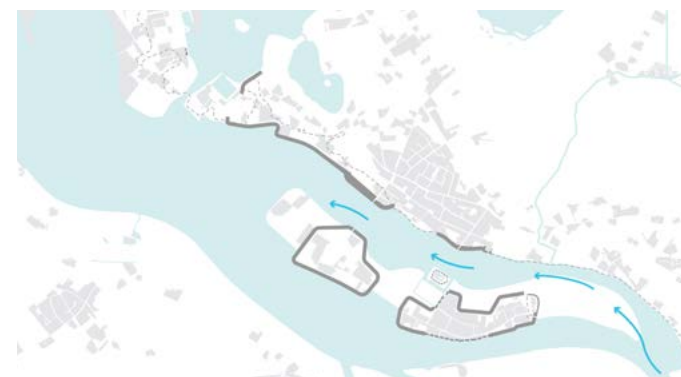
Figuur 15. Schema: Inschatting inundatie bij hoogwater 1x per 2 a 3 jaar: daarbij staan de lage delen van de Groene Rivier onder water, maar de akkers blijven nog droog.
