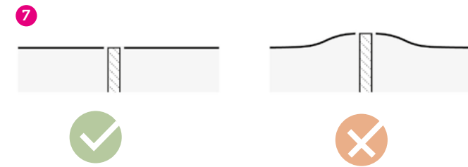
Figuur 93. Principe: Coupure op gelijke hoogte als wegdek.
