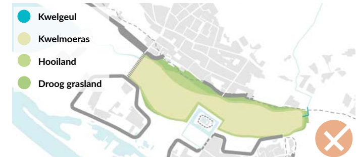
Figuur 31. Schematische impressie van inrichtingsbeeld bij het maaiveldvolgend afgraven van de Groene Rivier. Het gevolg is een groot kwelmoeras en ontbreken van open water.
