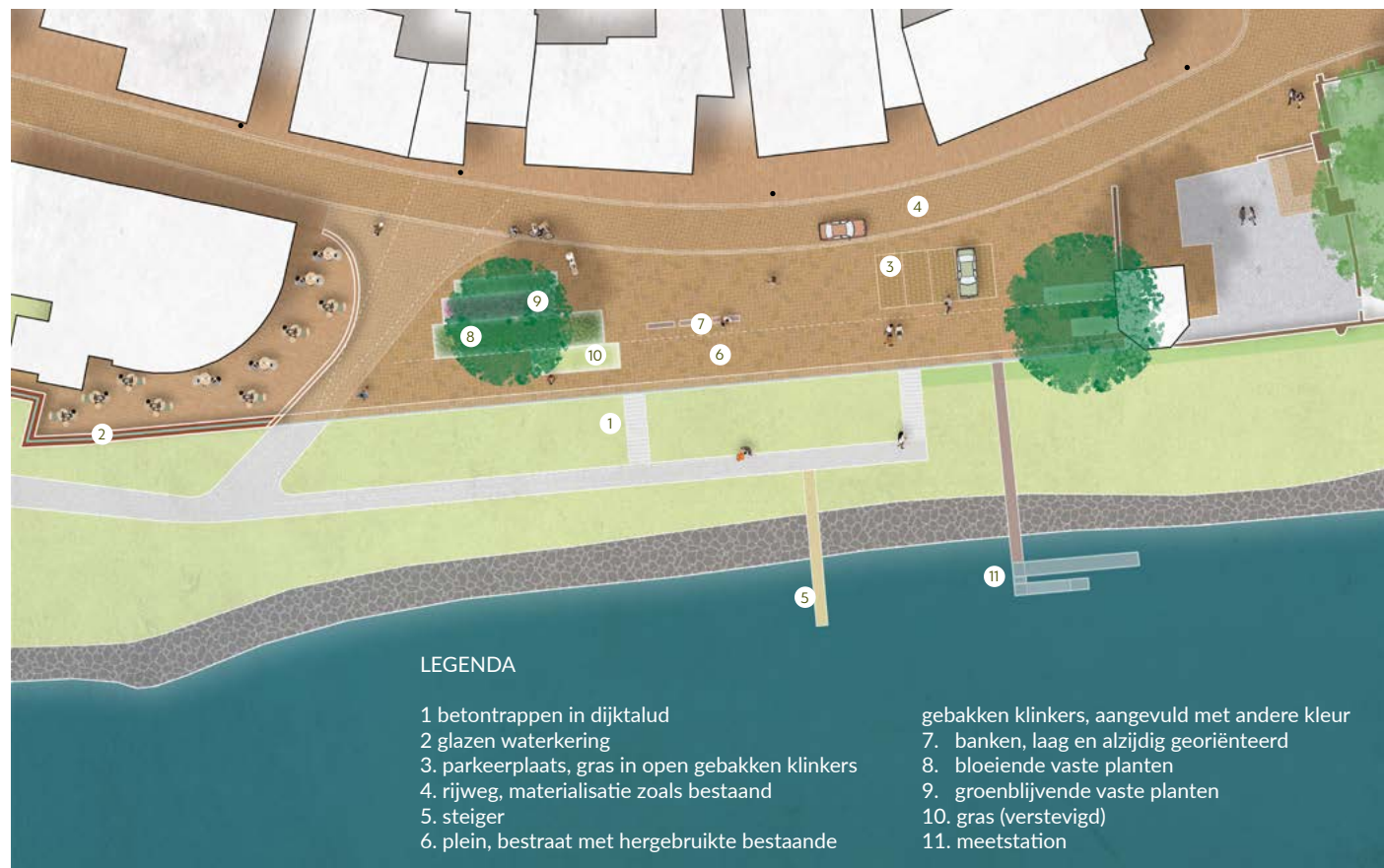
Figuur 194. Plankaart schetsontwerp sober en doelmatige inrichting
