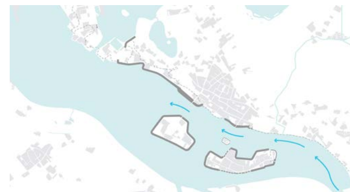
Figuur 16. Schema: Inschatting inundatie bij hoogwater 1x per 20 jaar: ook de akkers staan onder water, het water staat tot aan de dijk.
