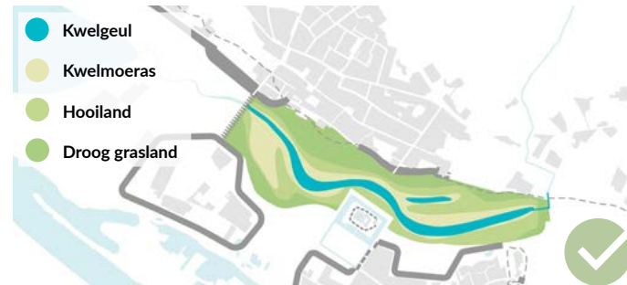
Figuur 27. Schematische impressie van bodemvolgend ontgraven t.p.v. restgeulen (= gedeeltelijk uitgraven), de overige ontgraving maaiveldvolgend.
