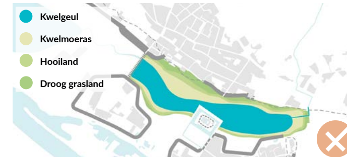
Figuur 29. Schematische impressie van inrichtingsbeeld bij het bodemvolgend afgraven van de Groene Rivier (= afgraven tot aan het zand). Het gevolg is grote plas water.
