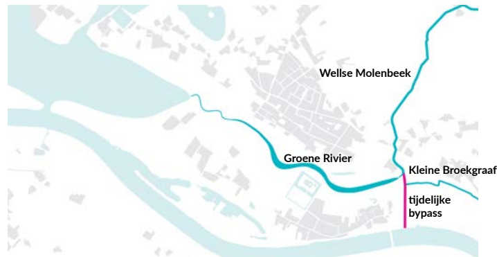
Figuur 57. Schema: Watersysteem, tijdelijke bypass ten behoeve van de waterkwaliteit.
