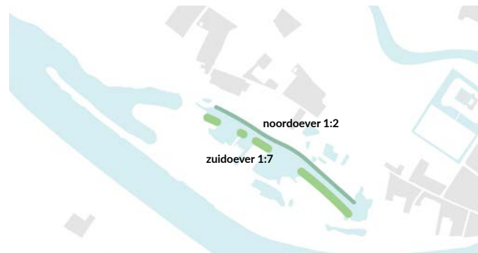
Figuur 49. Schema: Verschil in noord- en zuidoever De Band.
