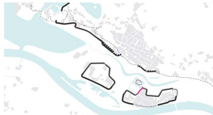
Figuur 78. Locatie constructieve kering Kasteellaan.
