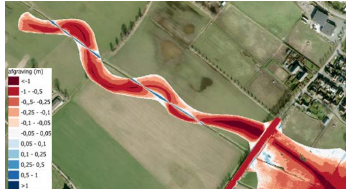
Figuur 38. Afgraving beek ten westen van de Elsterendijk; bron: RHDHV
