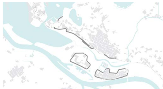
Figuur 14. Schema: Geen inundatie bij gemiddelde waterstand = stuwpeil Maas: er stroomt geen Maaswater door de Groene Rivier.
