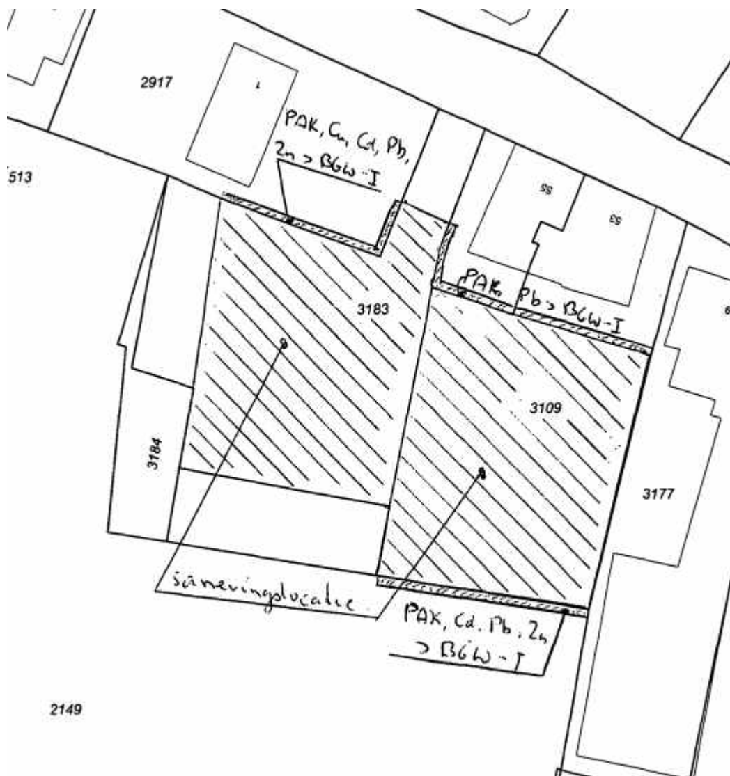
Figuur 12.3 Saneringslocatie en restverontreiniging LI089300043.
