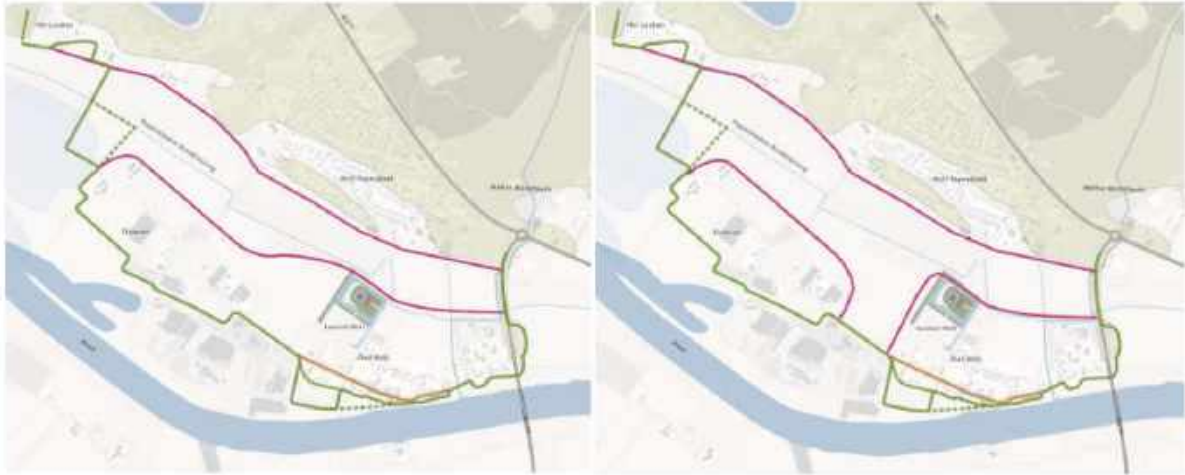
Figuur 3-3 Dijkalternatieven met één eiland (links) en twee eilanden (rechts), de groene rivier stroomt tussen de nieuwe dijken (roze lijnen)
