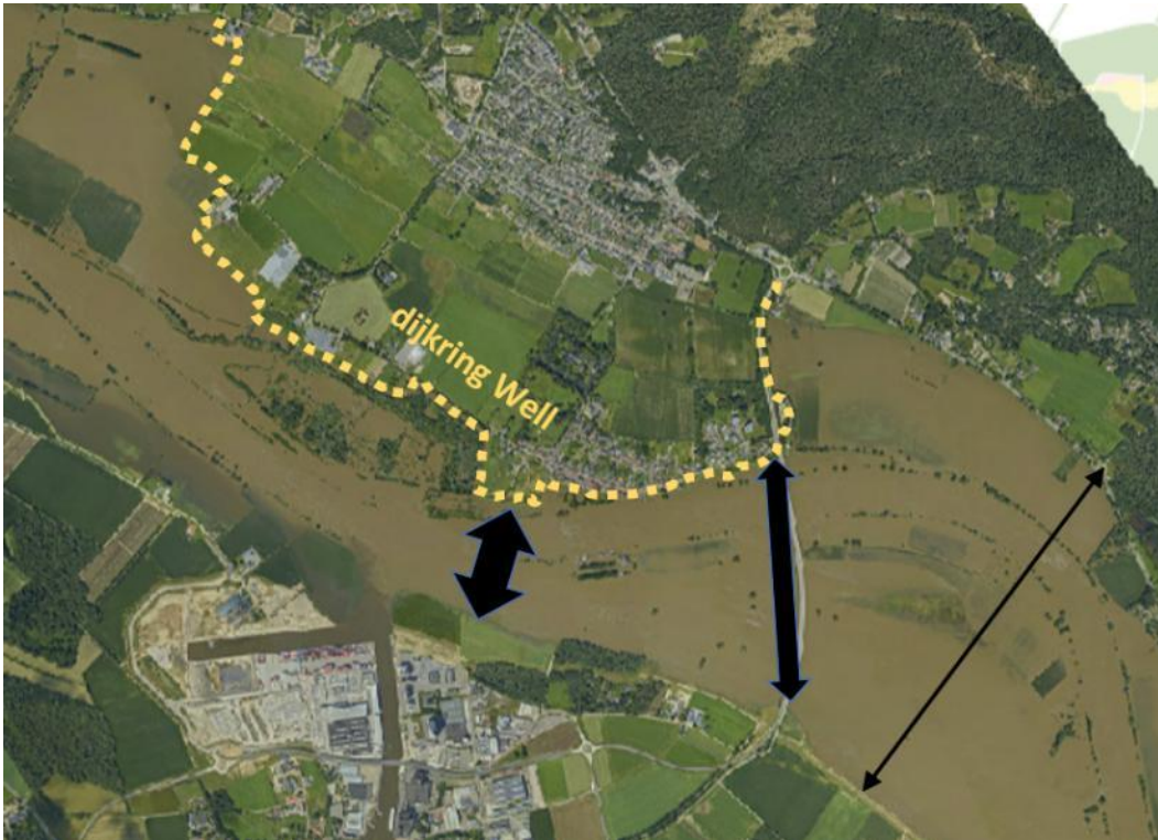
Figuur 2.5: De Maas tijdens het hoogwater van juli 2021. Het huidige dijktracé van Well vormt een duidelijke flessenhals in de rivier. Als gevolg hiervan wordt de Maas ingesnoerd en opgestuwd. Met pijlen is de afnemende breedte aangegeven van het beschikbare rivierbed als gevolg van N270 en het huidige dijktracé
