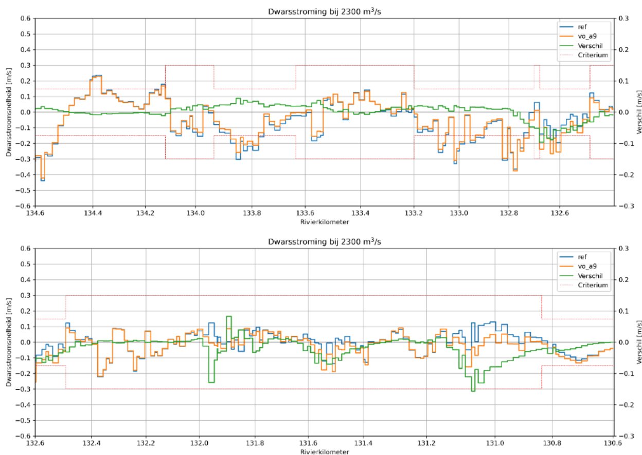
Figuur 7.5 Dwaarsstroming op de rand van de vaarweg (m/s) bij 2300 m 3 /s tussen het ontwerp (in figuur 'vo_a9') en de referentie (in figuur 'ref').
