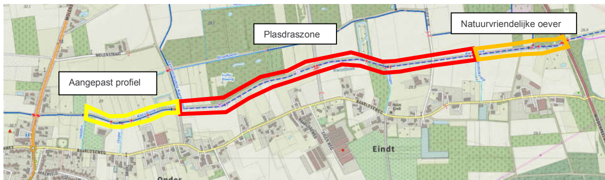
Figuur 3 Indeling profielen herinrichting bovenloop
