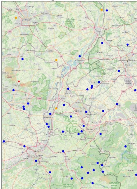
Figuur 31 (Links) Kaart van de provincie Limburg en omgeving met de locaties van de weerradar in Houthalen-Helchteren (rode driehoek), KNMI automatische regenmeters (oranje stippen) en lokale automatische regenmeters (blauwe stippen). (Rechts) Kaart van Nederland en omgeving met de locaties van weerradars (rode driehoeken), KNMI automatische regenmeters (oranje stippen) en KNMI-handregenmeters (groene stippen) © OpenStreetMap contributors
