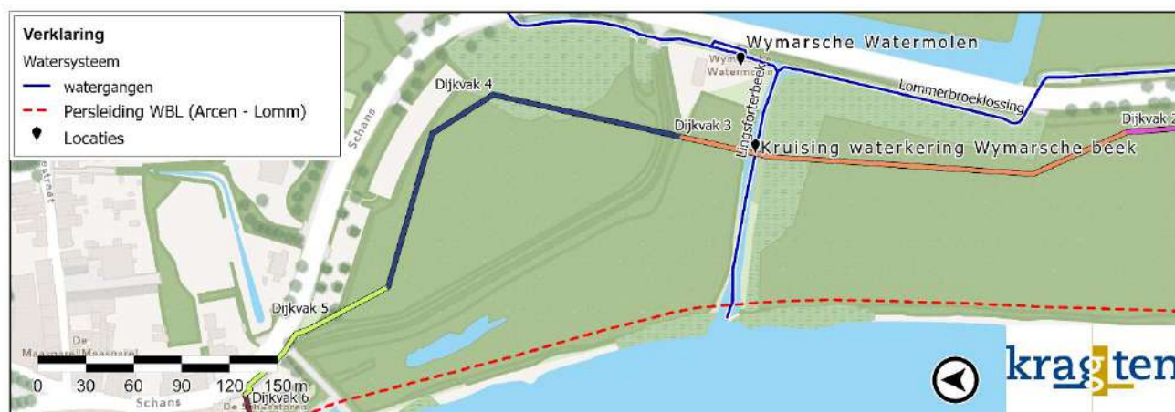
Afbeelding 7. Dijkvakken 3 en 4 met nieuwe kruising en persleiding van WBL.
