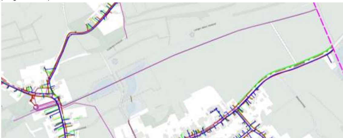
KLIC kaartmateriaal met WL persiolerings (paarse arcering) ter plaatse van Langen Akker (Kadaster, 2025)
