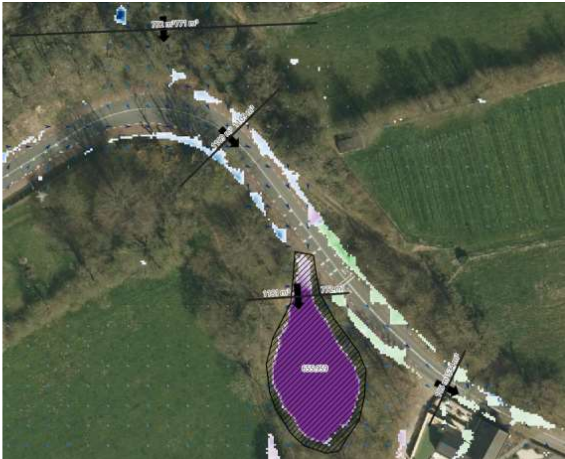
Hydrologisch T25 model van maatregel 5 met stroombanen en waterdiepte ter plaatse van Mheerelindje (Kragten, 2025)
