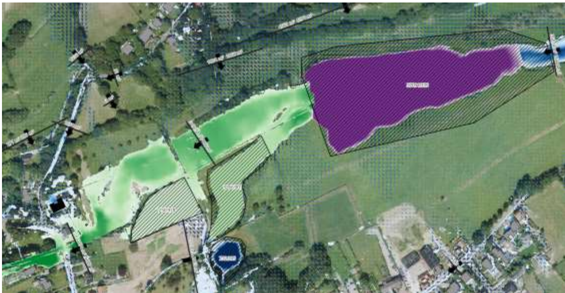
Hydrologisch T25 model van maatregel 1B met stroombanen en waterdiepte ter plaatse van Langen Akker (Kragten, 2025)
