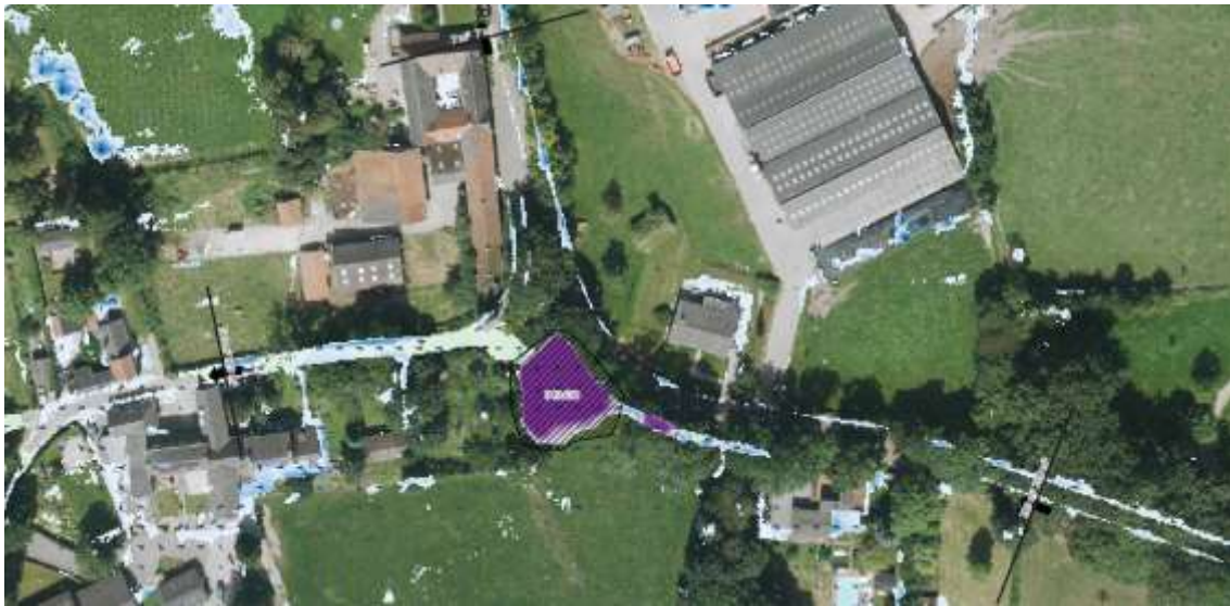
Hydrologisch T25 model van maatregel 14 met stroombanen en waterdiepte ter plaatse van Vroelen (Kragten, 2025)
