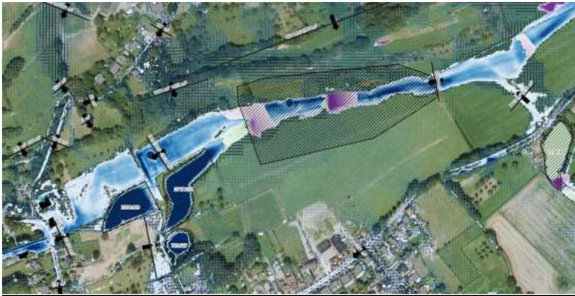
Hydrologisch T25 model van maatregel 1A met stroombanen en waterdiepte ter plaatse van Langen Akker (Kragten, 2025)
