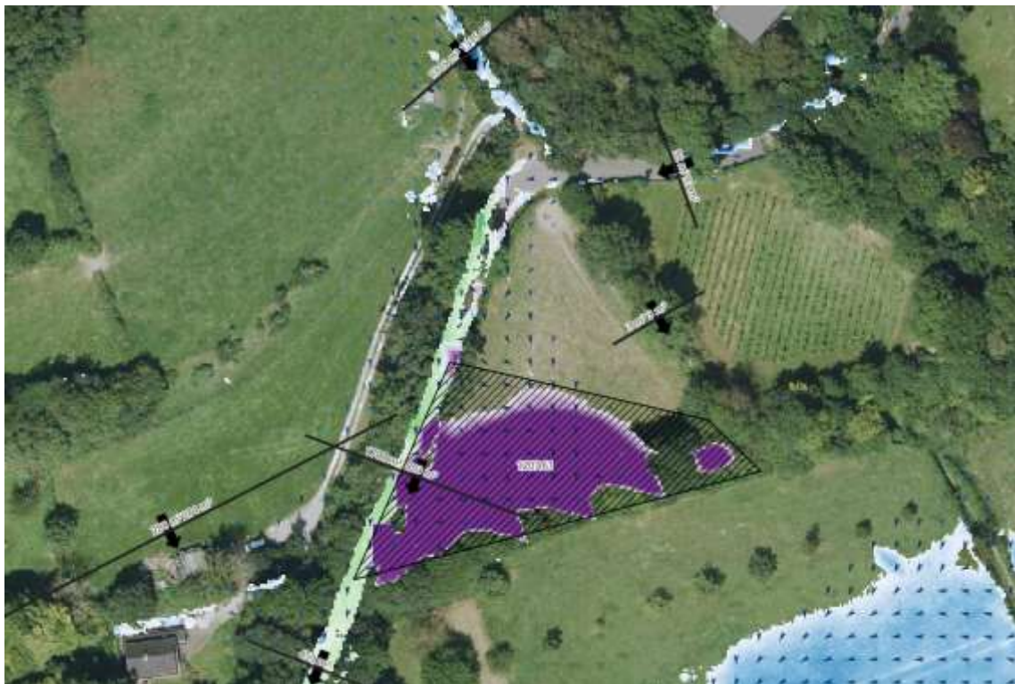
Hydrologisch T25 model van maatregel 10 met stroombanen en waterdiepte ter plaatse van Bergenhuizen (Kragten, 2025)
