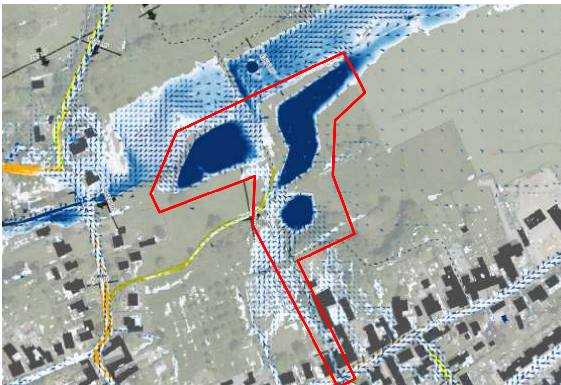
Hydrologisch T25 model huidige situatie met stroombanen en waterdiepte ter plaatse van Langen Akker (Kragten, 2025)
