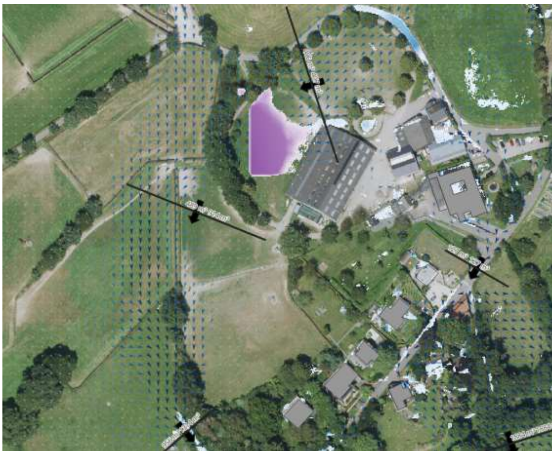
Hydrologisch T25 model van maatregel 9 met stroombanen en waterdiepte ter plaatse van Bergenhuizen (Kragten, 2025)
