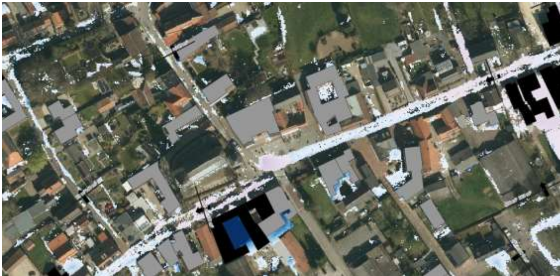
Hydrologisch T25 model van maatregel 4 met stroombanen en waterdiepte ter plaatse van Pley (Kragten, 2025)
