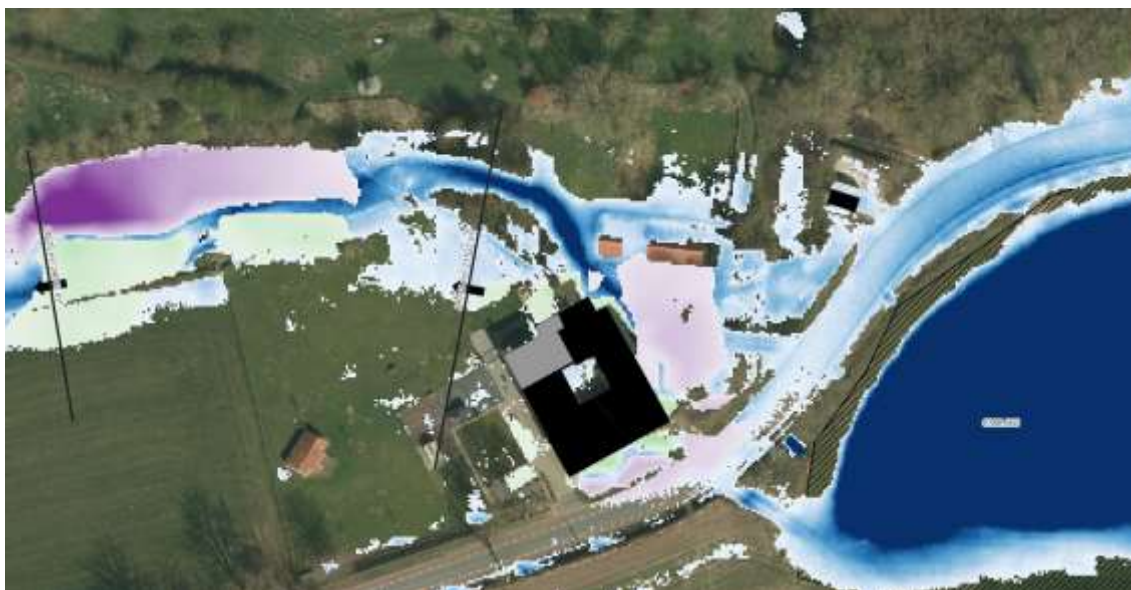
Hydrologisch T25 model van maatregel 11 met stroombanen en waterdiepte ter plaatse van Onderschey (Kragten, 2025)
