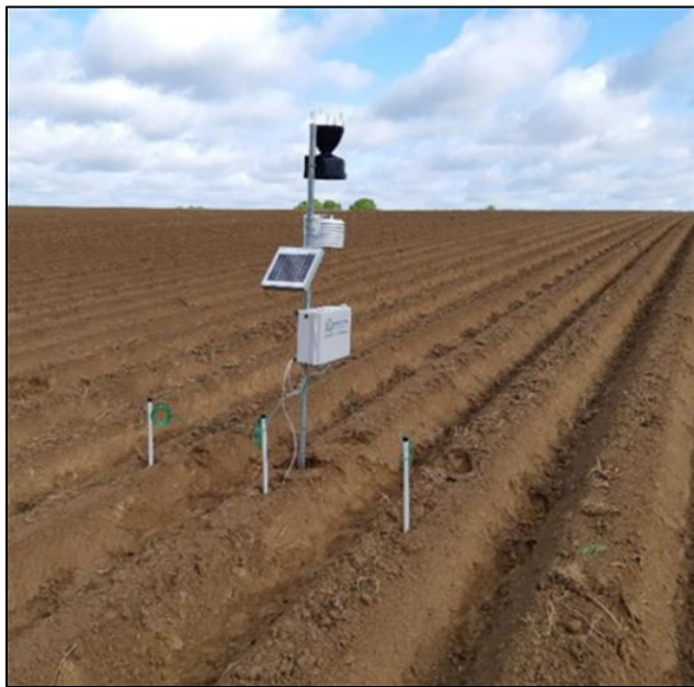
Afbeelding 1. Weerstations voor het meten, elke 5 minuten, van het actuele weer
