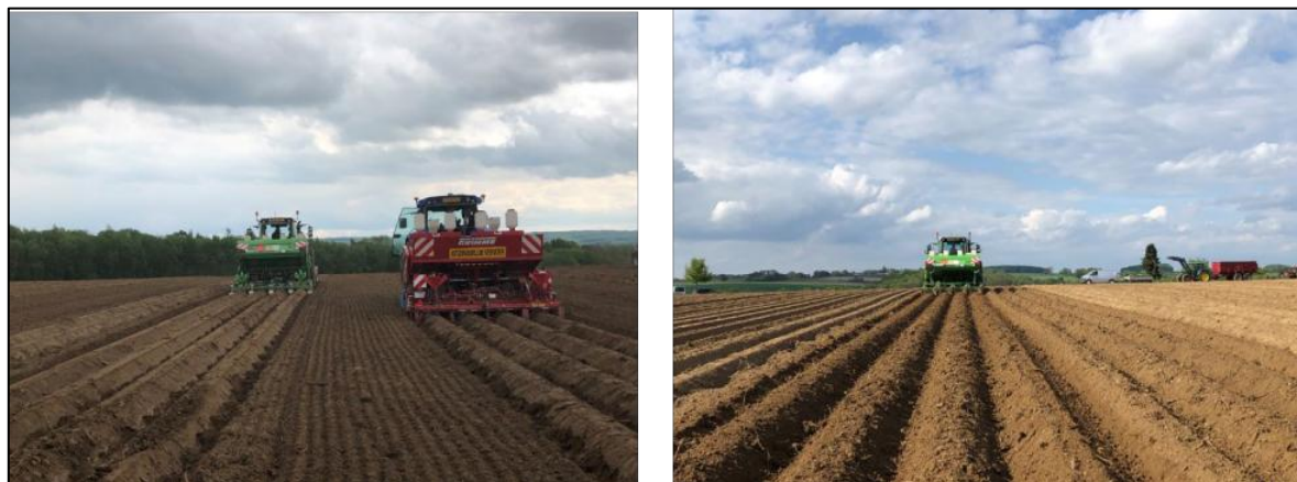
Afbeelding 4. Aanleg van de 5 objecten op 29 april 2020 in Baneheide van links naar rechts: AVR Ceres 400 met drempels, Grimme GL 420 met drempels en de AVR Ceres 400 met gitterrollen.
