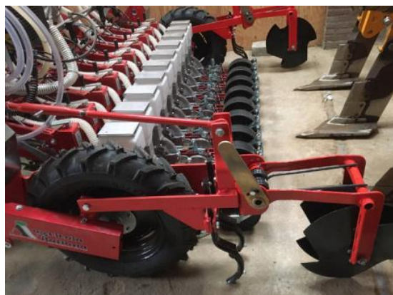
Afbeelding 35. Zaaimachine voor uien met drempelmaker in zaaispoor
