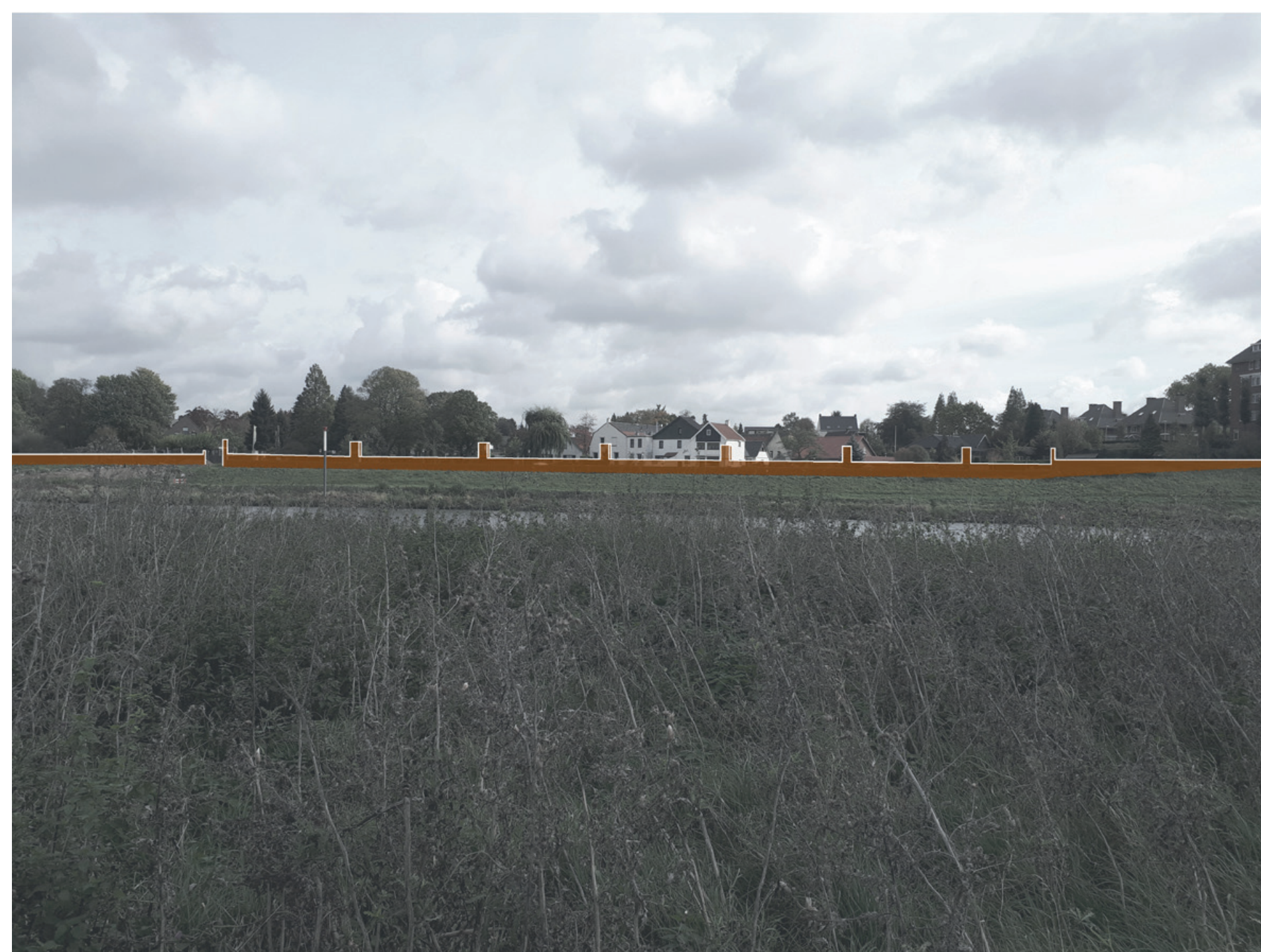
Overkant: zelfsluitende kering (drempel 19.2 NAP)
