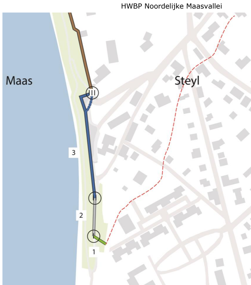
Figuur 26 Bovenaanzicht waterkering bij hoge grond (achter de rode stippellijn ligt de hoge grond)
