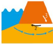
Piping en heave
