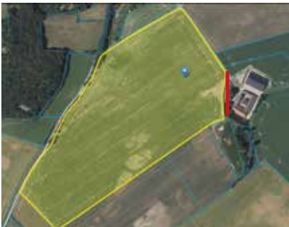
Gaston Backbier 2018 | Aanleg dijk (rood op kaartje) voor remmen piekafvoer water uit bovenliggende percelen (circa 15 ha) ter bescherming hoeve. Perceel-deel voor de dijk is buffergebied, mei 2018 water gebufferd met schade aan bietengewas.
