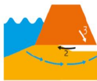
Piping en heave
