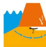
Piping en heave
