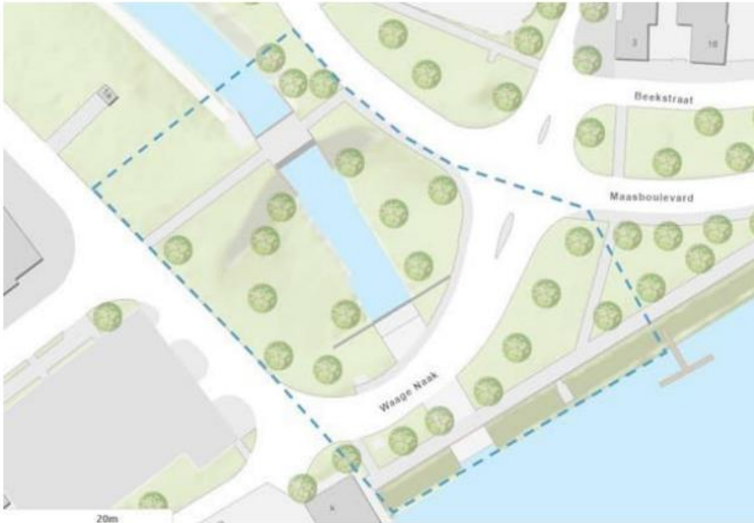
Figuur 5-29 Huidige inrichting gebied beekmondning en het ruimtebeslag waarbinnen de nieuwe beekmondning dient te worden uitgewerkt (blauwe stippellijn).
