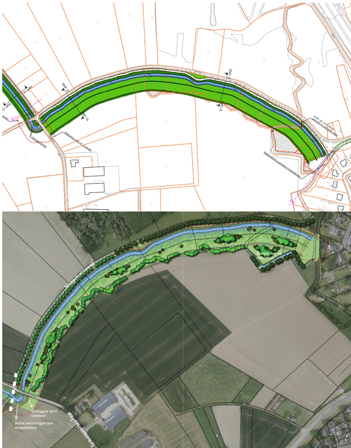
Figuur 5-22 Deeltraject D. Boven: inpassend ontwerp (iets gedraaid). Onder: Luchtfoto met landschappelijke inpassing.
