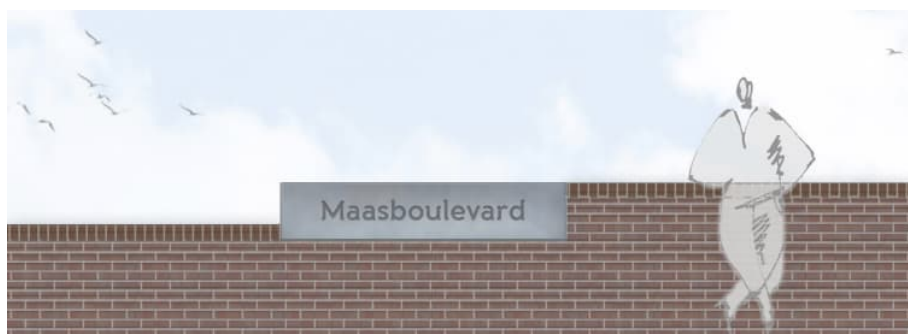
Figuur 4-26 In de gemetselde kademuur is een bescheiden accent verwerkt in bijvoorbeeld natuursteen.
