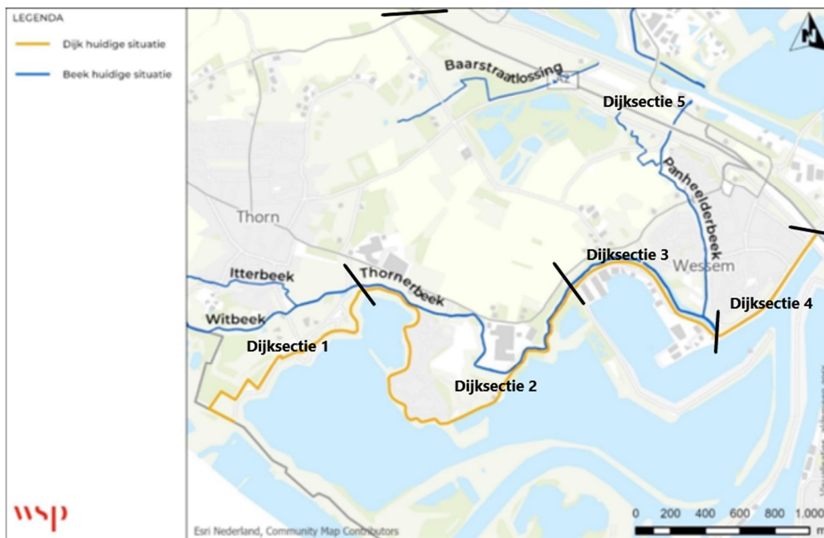
Figuur 2-4 Watersysteem inclusief waterkering
