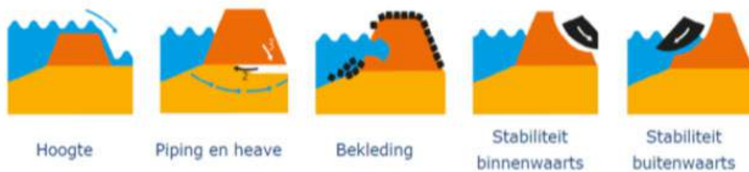
Figuur 0.1 Werking van de verschillende faalmechanismen
