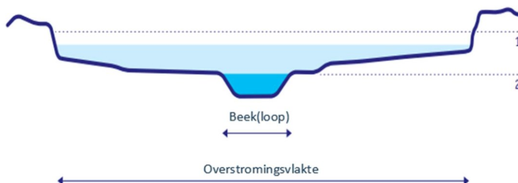
Figuur 3-22 Voorbeeld van een dwarsprofiel van de beek (Handboek geomorfologisch beekherstel, Stowa). In het VO-ontwerp is de beekloop aan de rand van de overstromingsvlakte gelegd. Zo is één zijde van het ontwerp ingericht volgens voor ecologie en de andere zijde volgens de eisen vanuit beheer en onderhoud.
