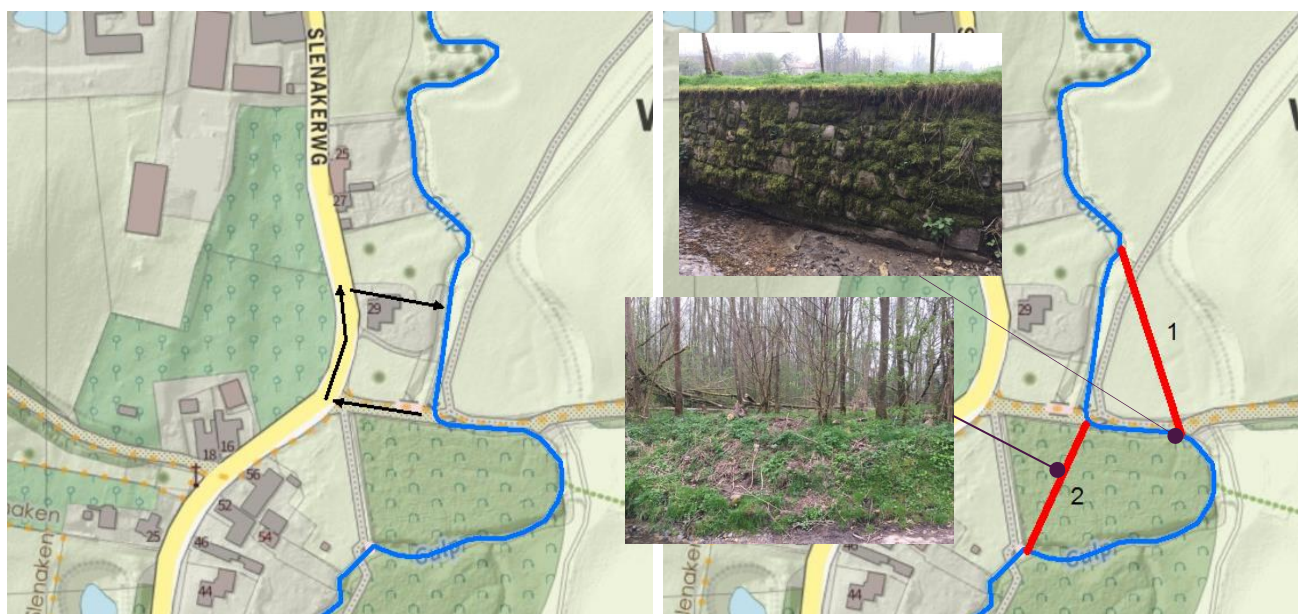
Figuur 8: Stromingspatroon (zwarte pijlen) rondom de woning van mevrouw Reijke bij afvoeren vanaf 10 \text{ m}^3/\text{s} . In rechterfiguur zijn in rood locaties voor mogelijke oplossingen aangegeven om het water beter te geleiden en wateroverlast ter plaatse van de woning te voorkomen.
