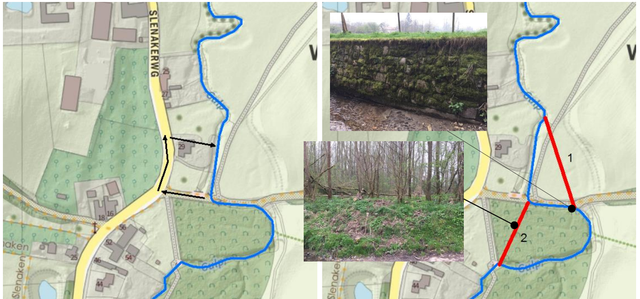
Figuur 1: Stromingspatroon (zwarte pijlen) rondom de woning Slenakerweg 29 bij afvoeren vanaf 10 \text{ m}^3/\text{s} . In rechterfiguur zijn in rood locaties voor mogelijke oplossingen aangegeven om het water beter te geleiden en wateroverlast ter plaatse van de woning te voorkomen.
