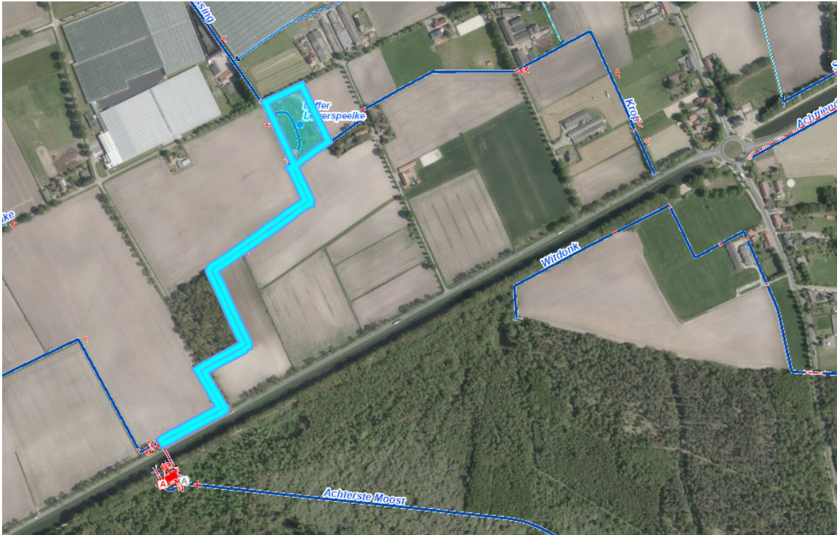
Figuur 1: Luchtfoto van het projectgebied. In het noorden het kassengebied en in het zuiden de Venloseweg. Links de watergang die we gaan verbreden en rechts watergang de krop, die we gaan opschonen.
