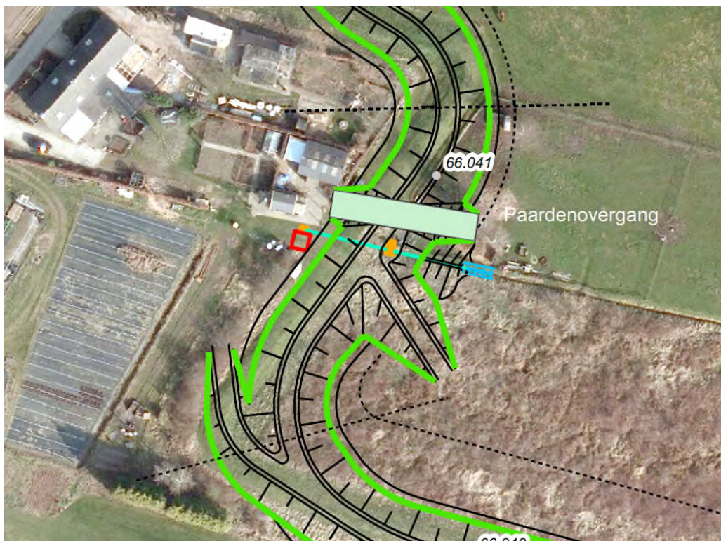
Figuur 4-26 Dijkvak 9: Groene dijk ter hoogte van Pastoor Kerboschlaan 12. De groene lijn geeft de teen aan van de dijk. Aan de buitenzijde is met een zwarte stippellijn de zone van de klei-inkassing weergegeven, die onder maaiveld wordt aangelegd. In rood is de pompostelplaats aangegeven. De inspectieputten zijn met oranje aangegeven, de duiker met turkoois. De lichtgroene box geeft de locatie van de paardenovergang aan. De stippellijnen dwars op de dijk markeren de grens van het dijkvak.
