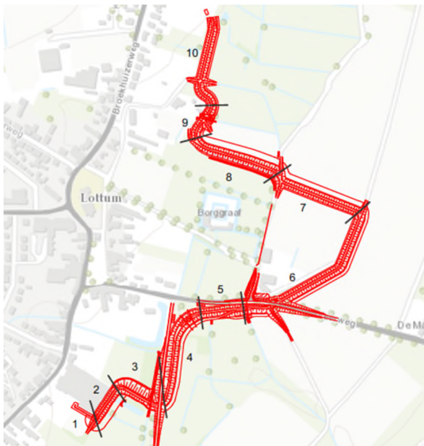
Figuur 3-3 Indeling dijkkring 66 in dijkdelen ten behoeve van het definitieve ontwerp
