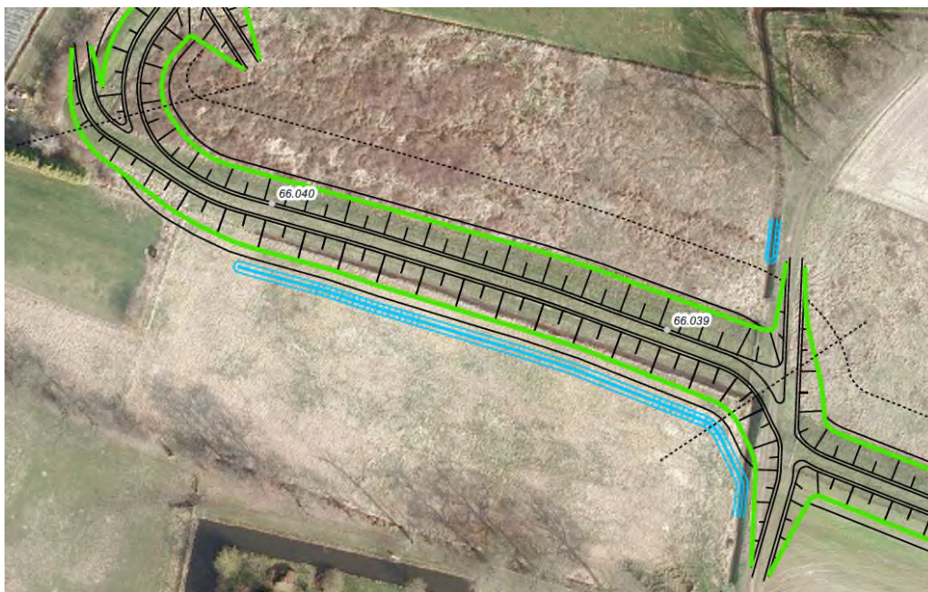
Figuur 4-23 Dijkvak 8: Groene dijk, in het verlengde van dijkvak 7. De groene lijn geeft de teen aan van de dijk. Aan de buitenzijde is met een zwarte stippellijn de zone van de klei-inkassing weergegeven, die onder maaiveld wordt aangelegd. De stippellijnen dwars op de dijk markeren de grens van het dijkvak.
