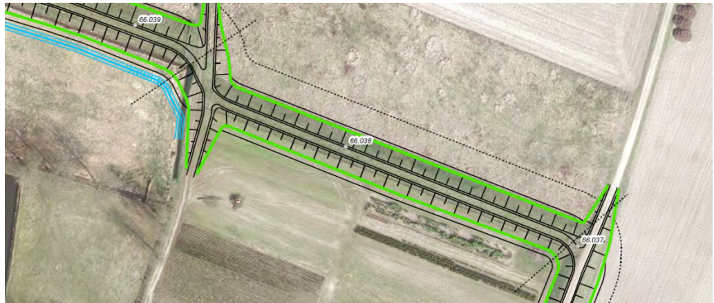
Figuur 4-21 Dijkvak 7: Groene dijk met een binnenwaartse dijk aanpassing. De groene lijn geeft de teen aan van de dijk. Aan de buitenzijde is met een zwarte stippellijn de zone van de klei-inkassing weergegeven, die onder maaiveld wordt aangelegd. De stippellijnen dwars op de dijk markeren de grens van het dijkvak.
