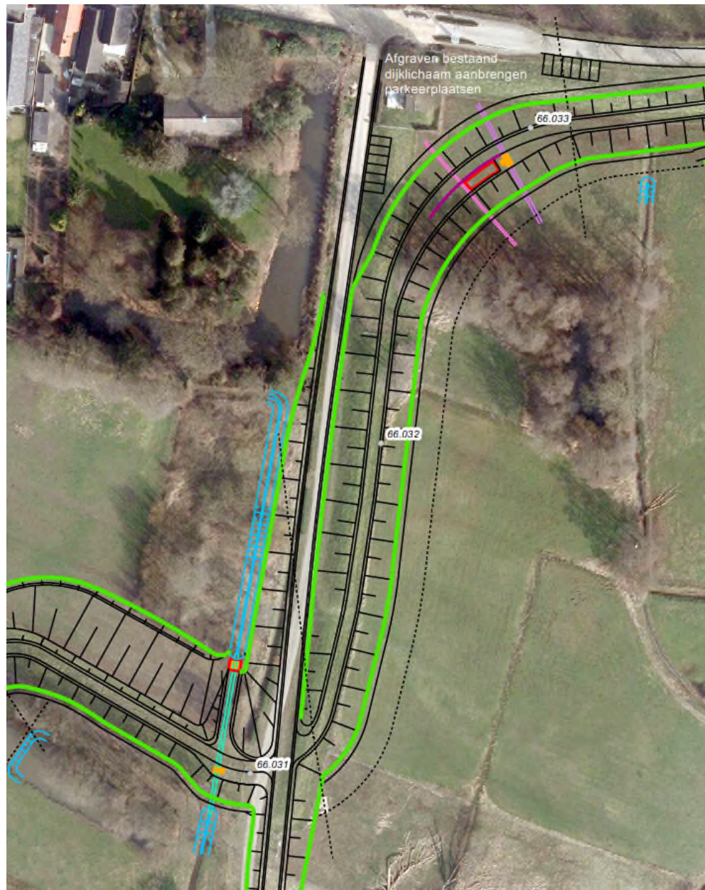
Figuur 4-10 Dijkvak 4: Groene dijk langs de Opperdonkseweg. De groene lijn geeft de teen aan van de dijk. Aan de buitenzijde is met een zwarte stippellijn de zone van de klei-inkassing weergegeven, die onder maaiveld wordt aangelegd. De stippellijnen dwars op de dijk markeren de grens van het dijkvak.
