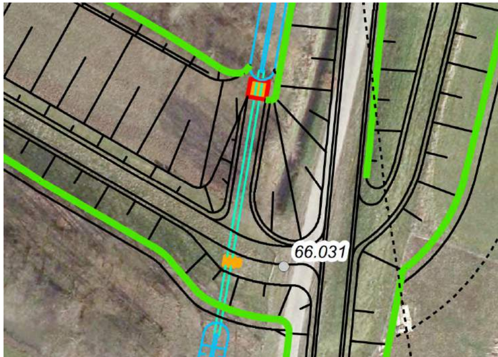
Figuur 4-9 Nieuwe situatie kunstwerk Siebersbeek (LOT01) met in turkoois de duiker, in rood de pompopstelplaats en in oranje de inspectieput.
