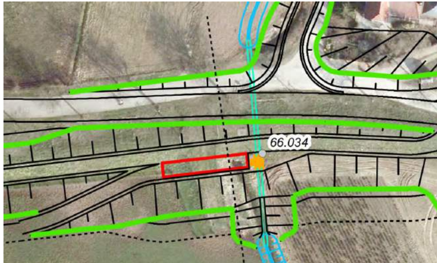
Figuur 4-19 Nieuwe situatie kunstwerk Tassbeek (LOT02) met in turkoois de duiker, in rood de pompopstelplaats en in oranje de inspectieput.
