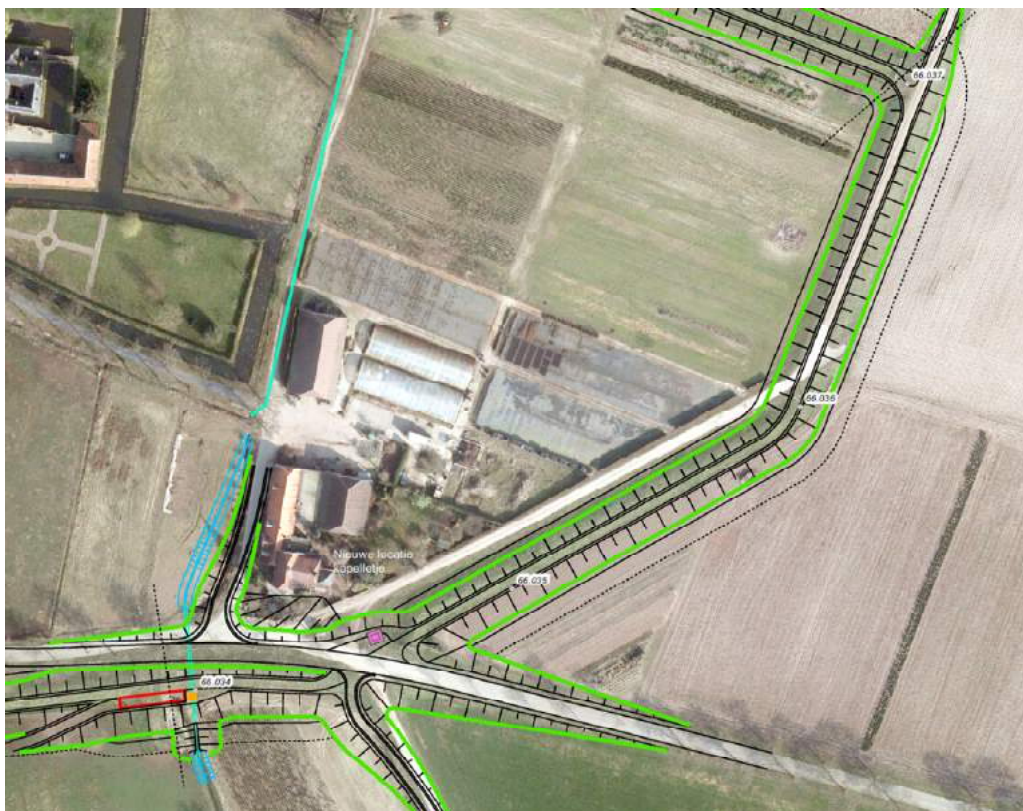
Figuur 4-17 Dijkvak 6: Groene dijk langs de Veerweg en de zijweg ervan. De groene lijn geeft de teen aan van de dijk. Aan de buitenzijde is met een zwarte stippellijn de zone van de klei-inkassing weergegeven, die onder maaiveld wordt aangelegd. De stippellijnen dwars op de dijk markeren de grens van het dijkvak.
