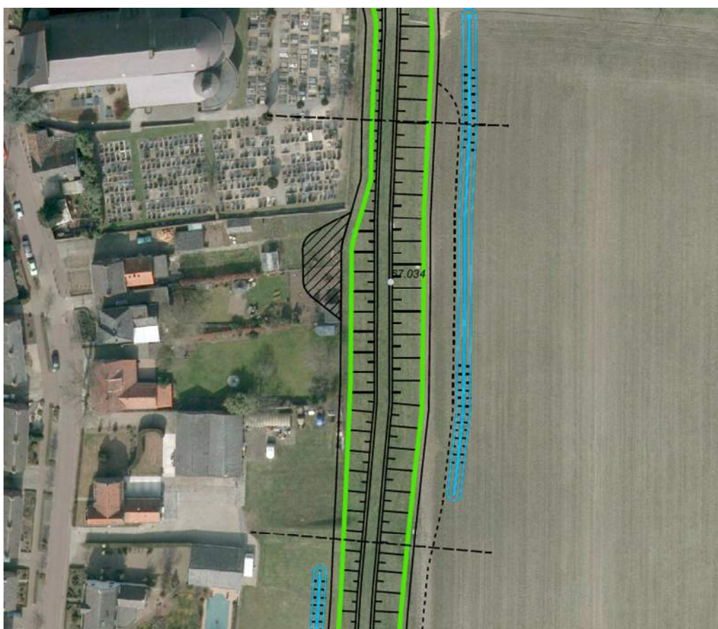
Figuur 4-12 Dijkvak 6: Groene dijk aan de achterzijde van de huizen aan de Kerkstraat. De groene lijn geeft de teen aan van de dijk. Aan de buitenzijde is met een zwarte stippellijn de zone van de klei-inkassing weergegeven, die onder maaiveld wordt aangelegd. De stippellijnen dwars op de dijk markeren de grens van het dijkvak.
