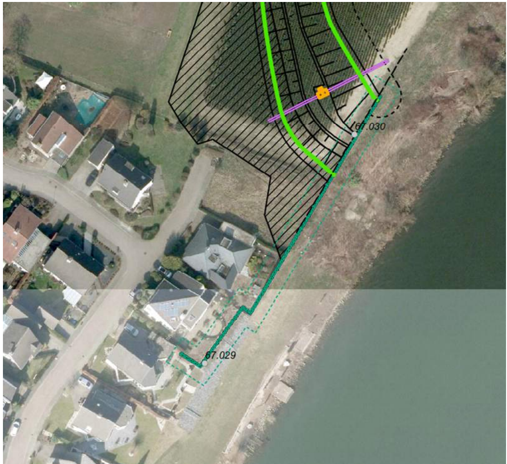
Figuur 4-4 Dijkvak 2: Aansluiting van huidige dijk op hoge gronden middels een damwand. Het dijkvak eindigt waar de groene kering begint, bij dijkpaal 67.030. De damwand loopt door over de breedte van de dijk.
