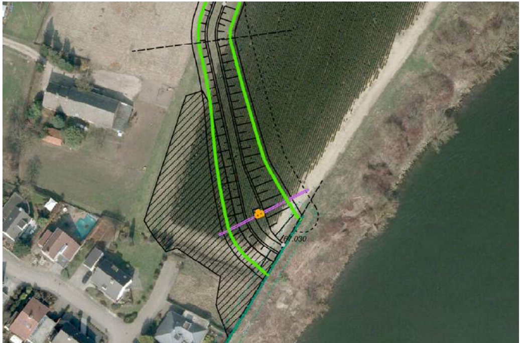
Figuur 4-6 Dijkvak 3: Groene dijk tussen de rand van de Maas en de oude loop van de dijk. De groene lijn geeft de knik aan van de dijk en het maaiveld / de binnenberm. Aan de binnenzijde wordt het lage maaiveld opgevuld tot NAP+17,50 m. Aan de buitenzijde is met een zwarte stippellijn de zone van de klei-inkassing weergegeven, die onder maaiveld wordt aangelegd. De stippellijnen dwars op de dijk markeren de grens van het dijkvak. De paarse lijn geeft de ligging van het vrijerval riool aan, met in oranje de put.
