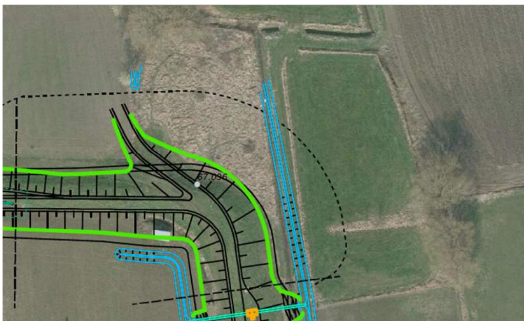
Figuur 4-16 Dijkvak 8: Groene dijk. De groene lijn geeft de teen aan van de dijk. Aan de buitenzijde is met een zwarte stippellijn de zone van de klei-inkassing weergegeven, die onder maaiveld wordt aangelegd. De stippellijnen dwars op de dijk markeren de grens van het dijkvak.
