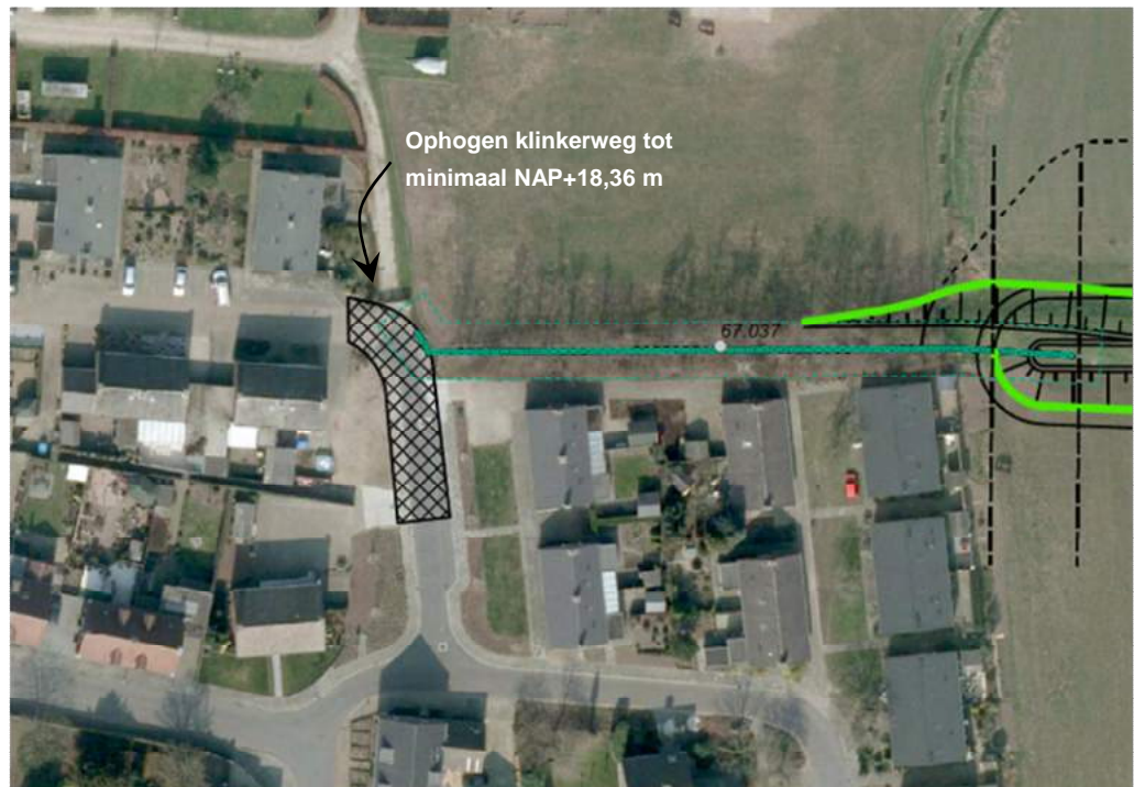
Figuur 4-19 Dijkvak 9 en 10: Damwand aan de noordzijde van de Doolingsbemden. De groene lijn geeft de teen aan van de dijk. Aan de buitenzijde is met een zwarte stippellijn de zone van de klei-inkassing weergegeven, die onder maaiveld wordt aangelegd. De stippellijnen dwars op de dijk markeren de grens van het dijkvak.
