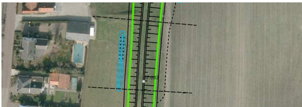
Figuur 4-10 Dijkvak 5: Groene dijk. De groene lijn geeft de teen aan van de dijk. Aan de buitenzijde is met een zwarte stippellijn de zone van de klei-inkassing weergegeven, die onder maaiveld wordt aangelegd. De stippellijnen dwars op de dijk markeren de grens van het dijkvak.
